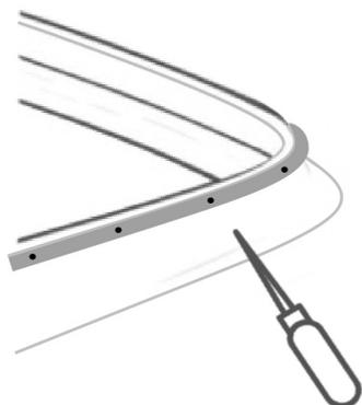
С помощью шила или отвертки, в местах установки элементов крепления рамки, делаем отверстия в уплотнителе, чтобы предотвратить налипание на винты клеевой основы.
